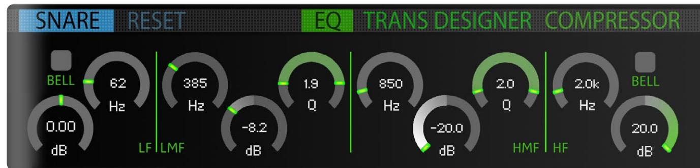
**LF GAIN** Dieser Verstärkungs-Parameter bestimmt den Grad der Anhebung oder Absenkung im Bereich derjenigen Frequenz, die mit dem Regler LF eingestellt wurde.
