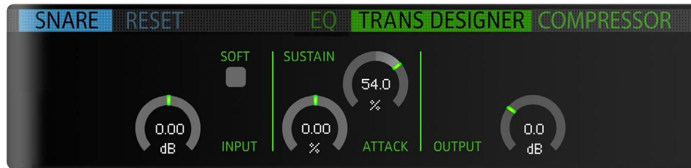
**SOFT** Der Transient Master ist hauptsächlich zur Bearbeitung von Drums oder perkussiven Klängen gedacht, sodass er bei deaktiviertem Soft-Schalter für den DrumMic'a! meist sehr gute Ergebnisse liefern wird – der Eingriff durch den TRANSIENT DESIGNER wird bei Extremeneinstellungen deutlich hörbar sein. Soll ein weniger tighter Eingriff in das Klangverhalten erzielt werden, etwa für möglichst unauffällige Bearbeitung bei Jazz Drums, lohnt sich der Versuch, den Soft-Schalter zu aktivieren.
